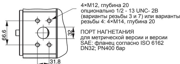
Выше показан насос с **вариантом монтажа К** и вариантом проходной передачи Т (подготовлен для проходной передачи).
