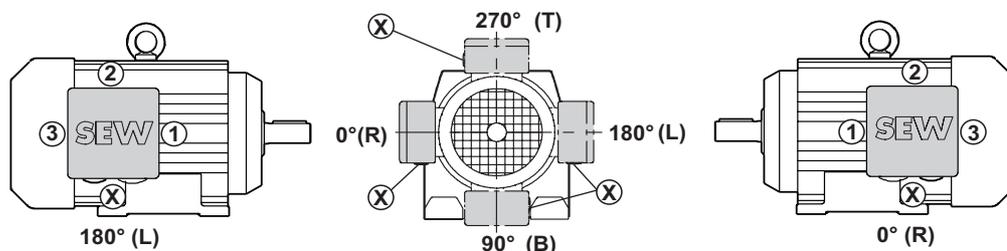
Рис. 56. Расположение клеммной коробки и кабельного ввода
