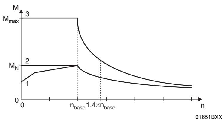
Рис. 44. Механическая характеристика в режиме работы CFC
