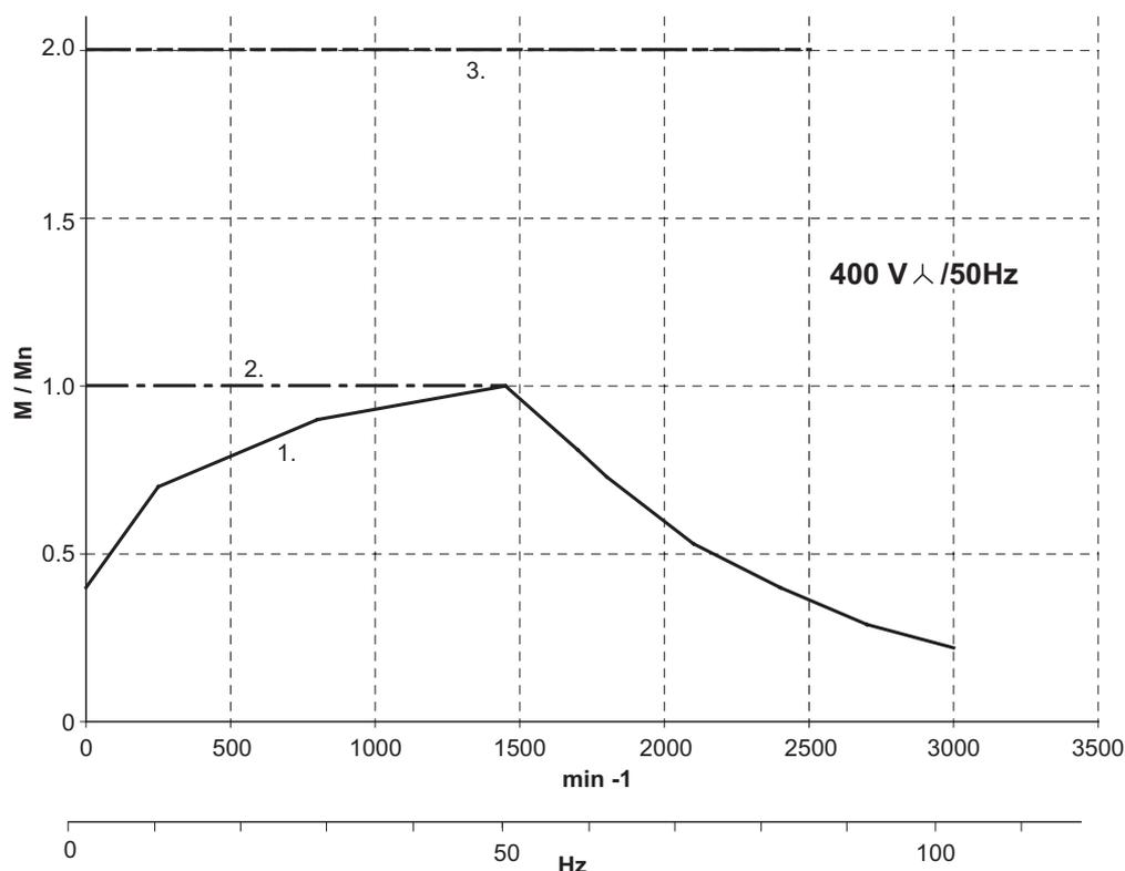
Рис. 58. Предельные механические характеристики при  $f_{base} = 50$  Гц
