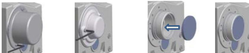
Рис. 11: Установка кожуха в исполнениях SH, H и H66
