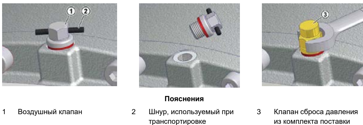
Рис. 4: Снятие воздушного клапана и установка клапана сброса давления
