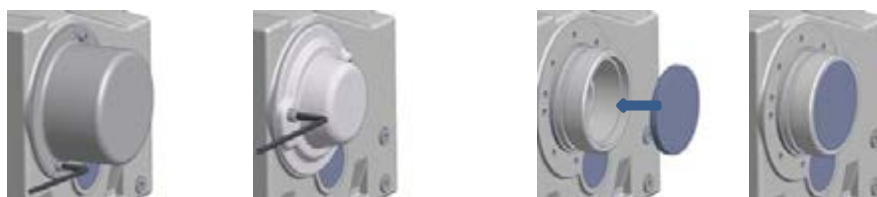
Рис. 15: Установка кожуха в исполнениях SH, Н и Н66
