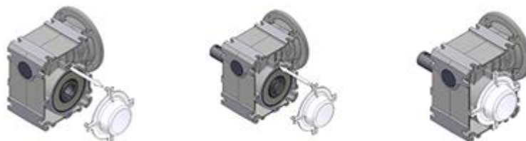
Рис. 16: Монтаж и демонтаж колпака
