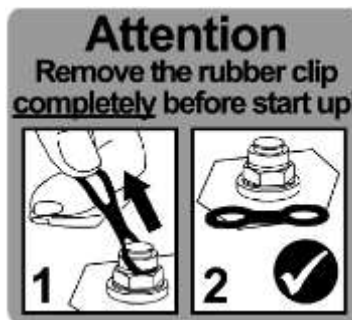
Figure 1: Информационный стикер (красно цвета) на редукторе
