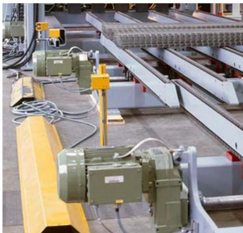
Рис. 2: Мотор-редуктор ASA 66A 114M4 TH с клеммной коробкой MIP
