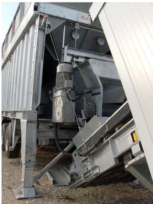
Рис. 1: Бункер и конвейер
