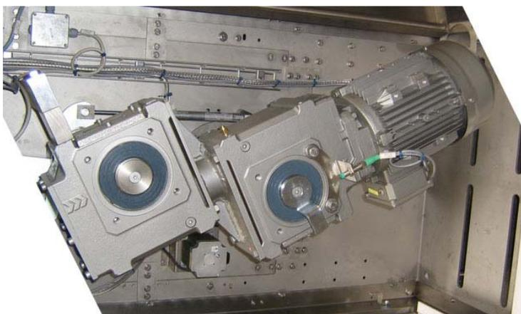
Рис. 2: Комбинированный мотор-редуктор SUA 608/608
