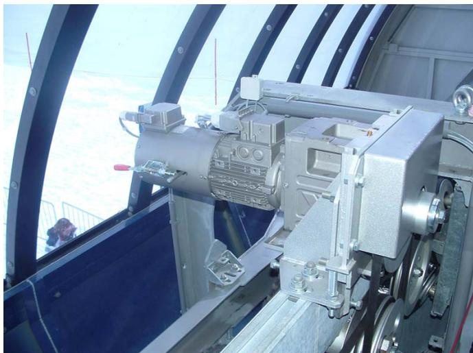
Рис. 3: Соосный мотор-редуктор WATT
