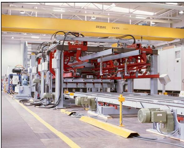
Рис. 1: Автоматические сварочные машины типа АТТ
