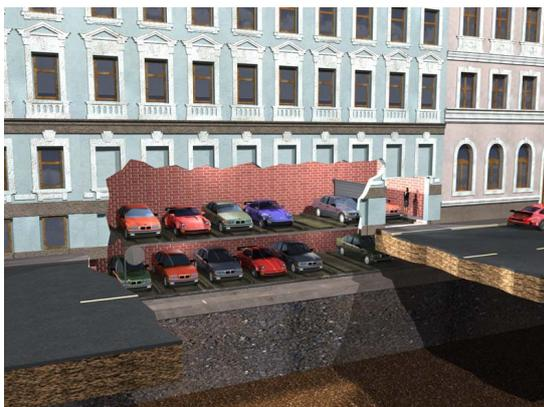
В данном применении Заказчик использует 4 мотор-редуктора на одну систему парковки, что является достаточным для транспортировки автомобилей без каких-либо затруднений. Быстрое время отклика системы, возможность использования для физически ограниченных лиц, а также безопасное управление - это и есть основные требования данного применения.
