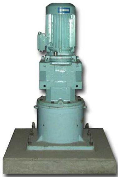
Рис. 1: Вертикально установленный мотор-редуктор FRA 130A 160M4
