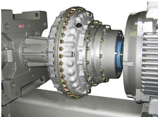
Рис. 1: гидравлическая муфта VOITH 487TV
