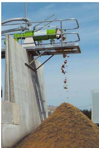
Рис. 1: Сепаратор S 655 в работе
