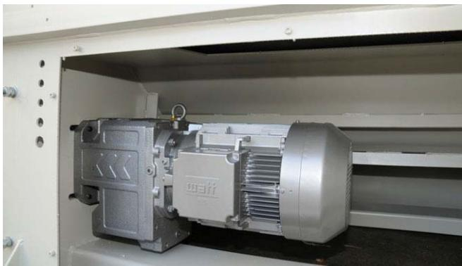
Рис. 1: Мотор-редуктор WATT НК 110А 134МL4 ТН
