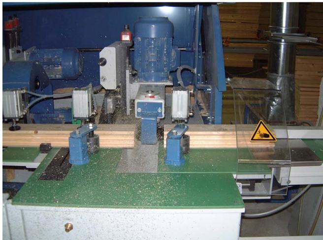
Рис. 1: Привод проточки торцевых канавок WAC 101L2 TH (3 кВт)
