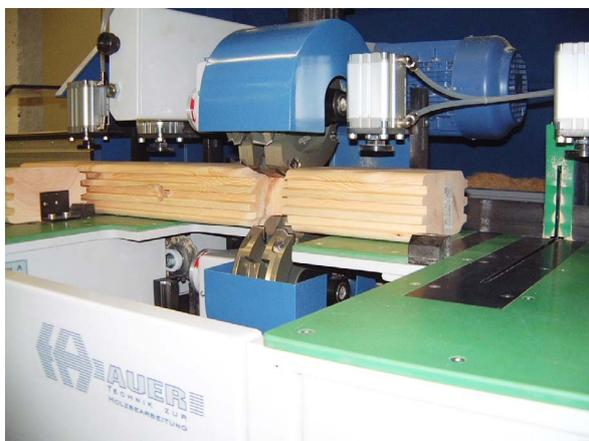
Рис. 2: 4-позиционный фрезерный станок с двигателем WEG EUSAS
