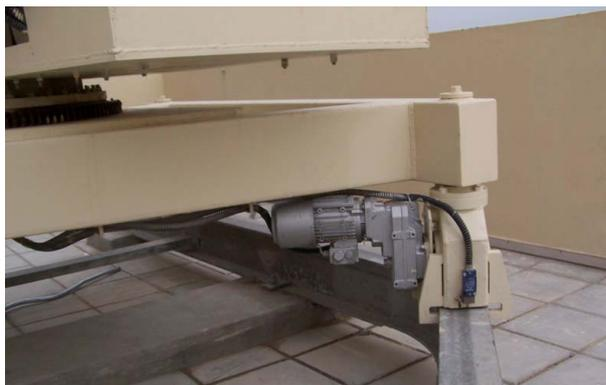
Рис. 2: Привод перемещения
