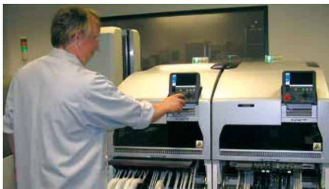
**Высокоскоростная установка для поверхностного монтажа**
